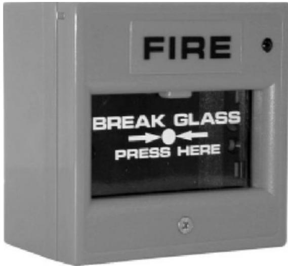
M500K是胜安智能火灾报警控制器专用编址火灾手动报警按钮，在发生火灾时按下玻璃，控制器报警并显示其地址，同时按钮本身LED点亮指示报警状态。
