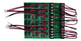
MR-2300-A: Module de conversion en classe A de six circuits de déclenchement
